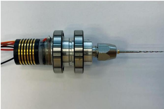
**Abb. 1 Demonstrator der Zahnfeile mit integriertem piezokeramischem Stapelaktor.**
